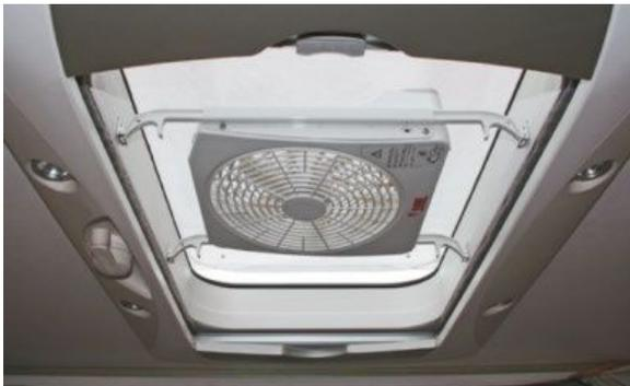
De la marque Fiamma, le Turbo Kit s'adapte sur les grands lanterneaux. Hélice de 24 cm et de 2 fixations télescopiques de 36 à 48 cm. Alimentation 12 V. Fonctionne en ventilateur et extracteur. Puissance 3 W, volume d'air maxi 5,4 m<sup>3</sup>/mn. Dimensions d'encastrement 36 à 48 x 31 cm.
