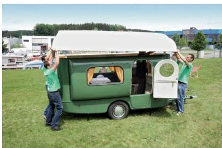
Le toit se déverrouille rapidement, il suffit alors de le retourner et de le mettre à l'eau pour continuer la promenade.
