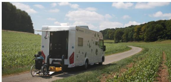
Au programme des aménagements de ce véhicule de loisir, vous découvrirez un astucieux système à l'arrière qui permet d'accéder en fauteuil roulant grâce à une plateforme élévatrice télécommandée. Le lit transversal arrière se replie en un clin d'œil, dégageant un large passage pour une personne en situation de handicap.
